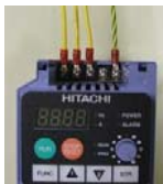
Připojení třífázového vstupu (modely -NFU, -HFEF a HFU)
