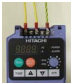
Připojení jednofázového vstupu (modely -SFEF a NFU)
